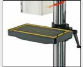
PG: 325 x 325 mm Schwenkbare Grundplatte
