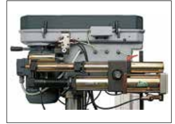
Cod. 30019: Hydro-pneumatischer Spindelvorschub. Automatischer Spindelvorschub UR80 von 90/105 mm mit schnellem Rücklauf auf die eingestellten Tiefe. Vorschub: 5-2500 mm/min. Schubkraft: bei 6 bar = 4000 N
