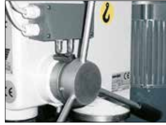
Cod. 18080: Gewindeschneideeinrichtung mit Drehrichtungswender.
